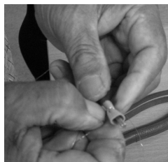
圖12.以銅線纏繞基座部位
