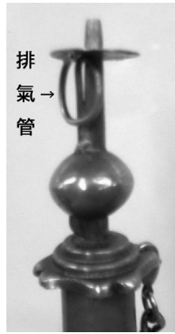
圖23.加上排氣管的戧管
